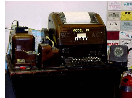
Primo sistema utilizzato per la trasmissione di testi in Onde Corte. Ancora molto usato:
